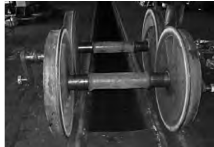
Die erste und zweite Achse nach der Demontage im Ausbesserungswerk. Die Radsatzwellen müssen erneuert werden.
