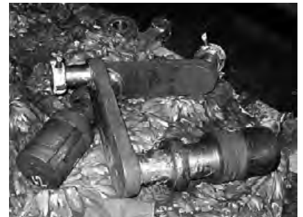
Nur noch Schrott: Verschlissene Treib- und Kuppelzapfen
