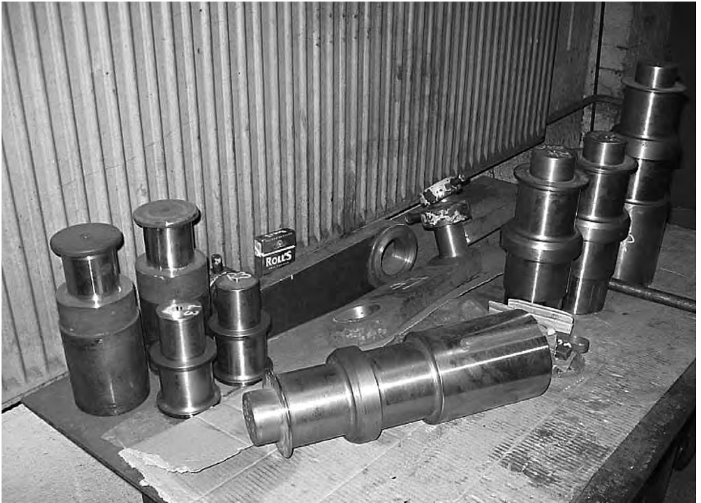
Bild 5 Neue Kuppel- und Treibzapfen sowie aufgearbeitete Schwingenkurbeln
