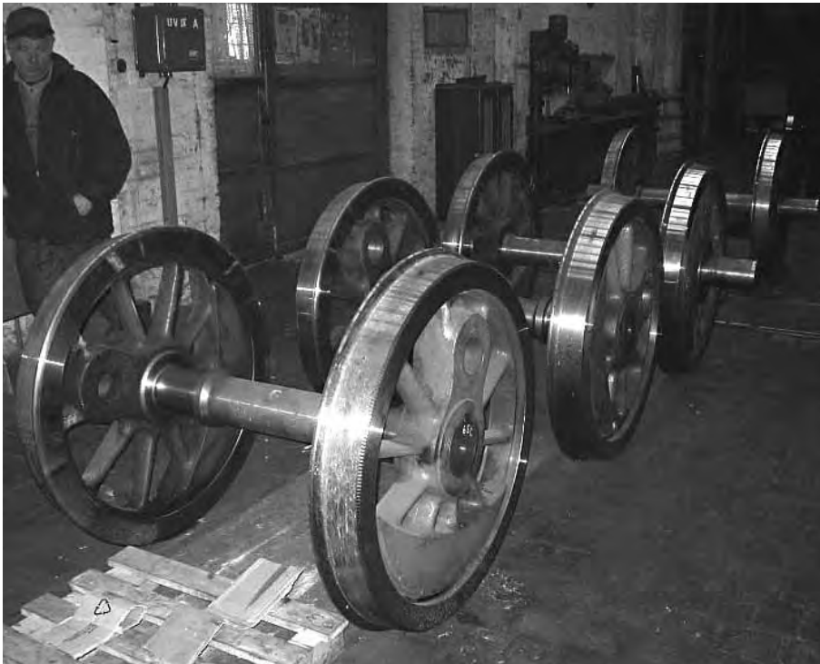
Bild 6 Neu bereifte Radsatzgruppe mit erneuerten Achswellen
